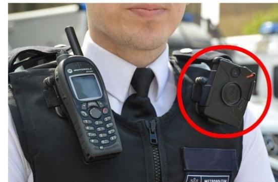
これは米Taser製の警官専用カメラ「AXON body」で価格は299ドル。市販はしていない。ボタンあるいは上部をスライドすることで動画撮影を開始でき、VGAの動画を4時間まで録画できる。録画中は上部のLEDランプが点灯する。視野角は130度と広角で、1ルクス以下の暗い場所でも録画が可能だ。録画した動画は設定によって自動的にクラウドに転送
